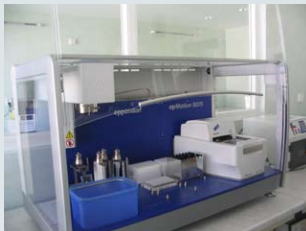
Pracovisko KEÚPZ je špičково vybavené. V takomto prístroji môže prebiehať izolácia aj stoviek vzoriek naraz, chránená pred kontamináciou.
