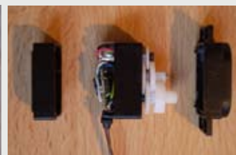
Opatrne otvoríme predný aj zadný kryt tak, aby sme nezberali zo zeme prevodové kolieska.
