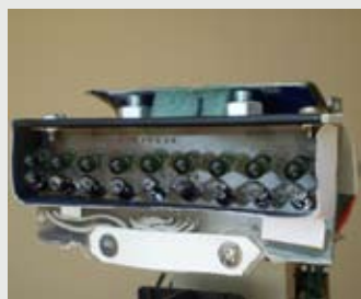
Robot s deviatimi „očami“ – dvojicami svetelných diód a fotodiód na podvozku
