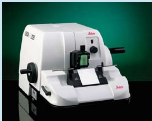
Vzorky nakrájané na mikrotóme sú také tenké, že obsahujú iba jedinú vrstvu buniek
