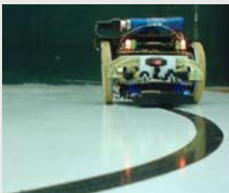
Robot s deviatimi „očami“ – dvojicami svetelných diód a fotodiód na podvozku
