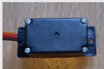
Skrinku servomotora otvoríme odmontovaním štyroch skrutiek na zadnej strane.
