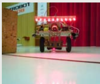
Robot s kamerou. Na dráhu si svieti červenými diódami.
