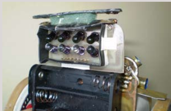
Pohľad zospodu. Vidíme v rade štyri dvojice svetelnej LED diódy a fotodiódy. Robot dokáže zistiť, pod ktorou dvojicou sa práve nachádza tmavá čiar a na základe tejto informácie vypočíta smer pohybu tak, aby čiaru neopustil.
