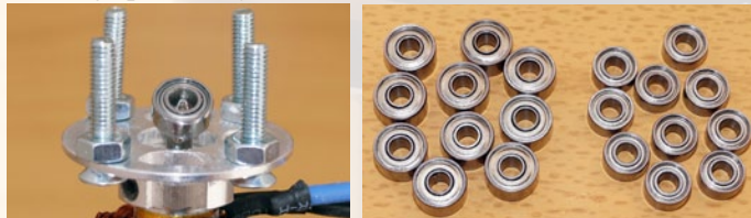
Výberanie jedného ložiska a náhradné ocelové ložiská
